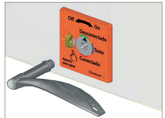
Operações realizadas externamente. Bloqueio automático por estágio e trava para cadeado em todas as posições.
